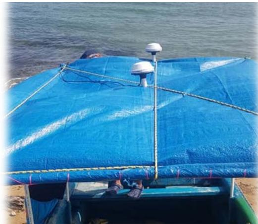
**Foto 6. Posición de las antenas GPS en la embarcación**
