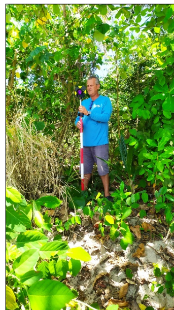
Fotos 5-9. Medición de perfiles de playa a lo largo de la playa de Bonasse con una estación total Leica TS-09 Plus.
