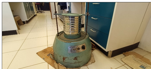
Foto 20. Tamizadora Endecotts Octagon con juego de tamices.
