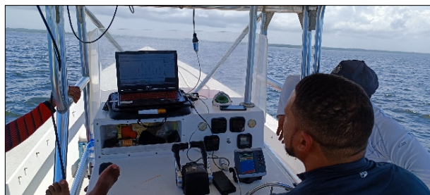
Fotos 65 y 66. Ejecución del levantamiento batimétrico de la zona de préstamo de arena a escala 1/15000.
