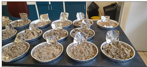
Foto 18. Muestras de arena secadas en el horno durante 24 horas.
