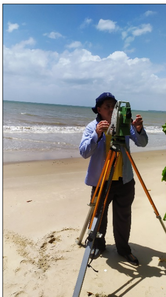
Fotos 5-9. Medición de perfiles de playa a lo largo de la playa de Bonasse con una estación total Leica TS-09 Plus.
