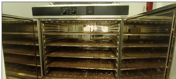
Foto 17. Estufa Memmert Be20 utilizada para el secado de las muestras.
