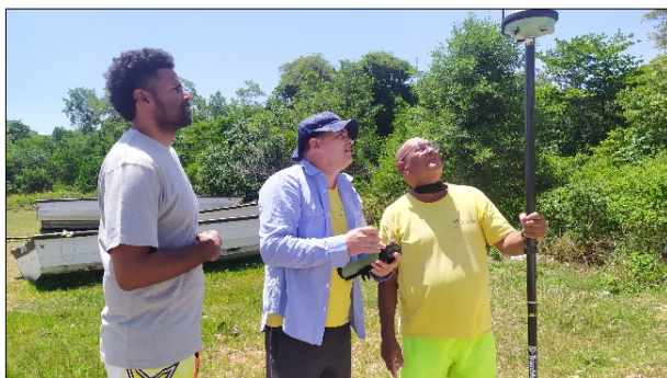
Fotos 3 y 4. Establecimiento de puntos topográficos que sirven como cabezas de los perfiles de playa para la caracterización de la morfología del perfil.
