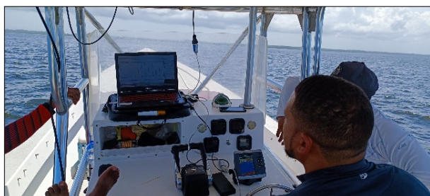
Fotos 12 y 13. Ejecución del levantamiento batimétrico con el software HYPACK MAX 64.
