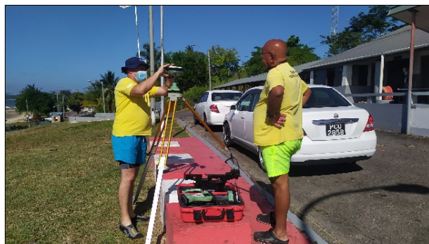
Fotos 1 y 2. Instalación de la estación base en las instalaciones de la Guardia Costera de Bonasse. Utilizando el GS-14 GNSS Leica en modo RTK..
