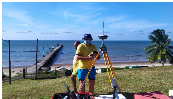
Fotos 1 y 2. Instalación de la estación base en las instalaciones de la Guardia Costera de Bonasse. Utilizando el GS-14 GNSS Leica en modo RTK..
