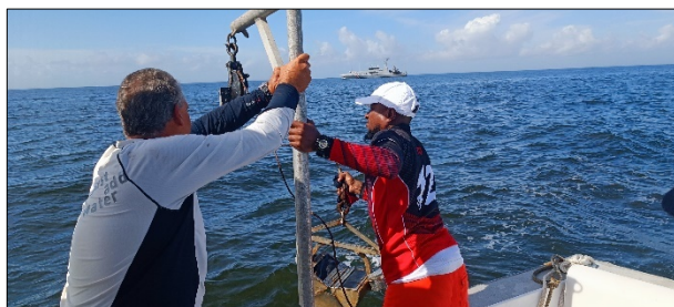
Fotos 63 y 64. Colecta de muestras de sedimentos con el empleo de jibia y winche.
