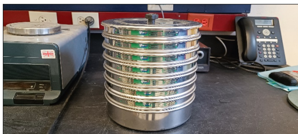
Foto 19. Juego de tamices utilizados para el tamizado de las muestras.
