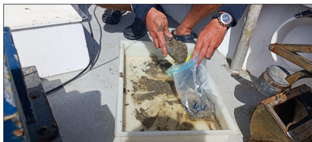
Fotos 63 y 64. Colecta de muestras de sedimentos con el empleo de jibia y winche.
