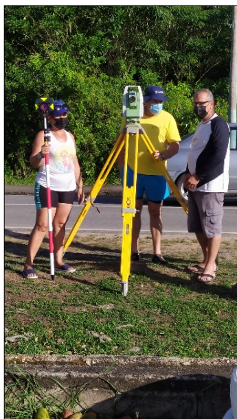
Fotos 5-9. Medición de perfiles de playa a lo largo de la playa de Bonasse con una estación total Leica TS-09 Plus.
