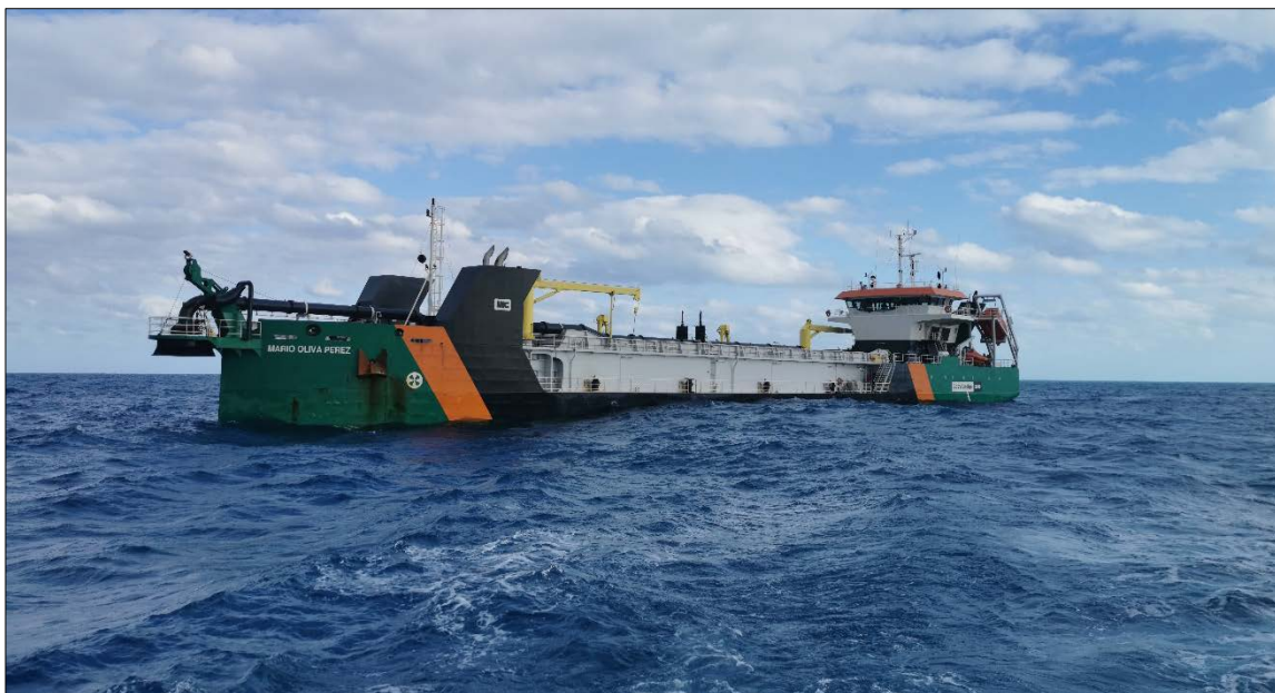
Foto 71. Ejemplo de draga de succión en marcha con características idóneas para la ejecución del proyecto. (Draga Mario Oliva Pérez, Empresa Constructora de Obras Marítimas, Cuba)
